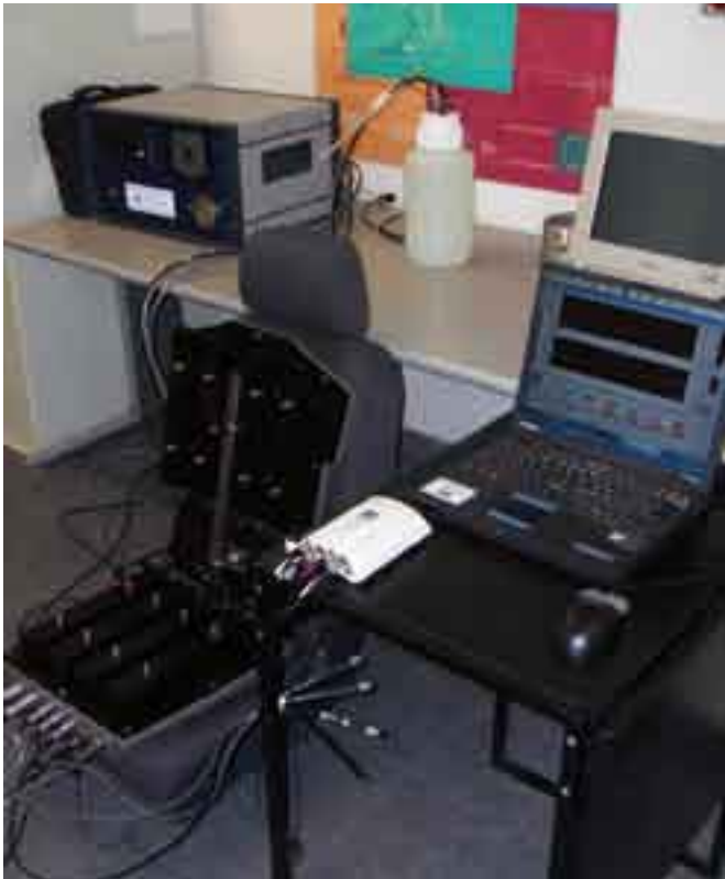
Figura 1. Ensayo con asientos en laboratorio con maniquí de confort térmico STAN.
