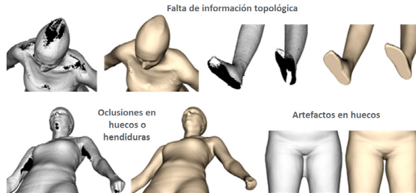
Figura 1. Errores habituales encontrados en las mallas resultado del proceso de adquisición corporal 3D.
