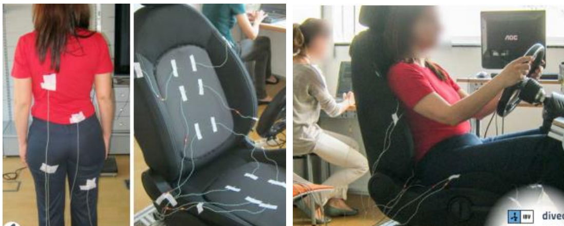
Instrumentación del sujeto y el asiento para la realización de ensayos con usuarios.
