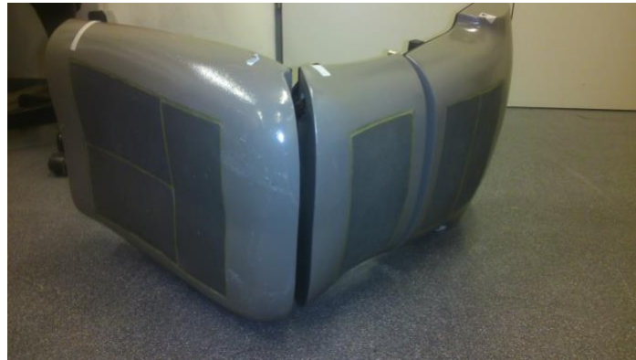
Izquierda: Maniquí con pesas. Derecha: STAN equipado con paneles para la sudoración de la piel de metal poroso.
