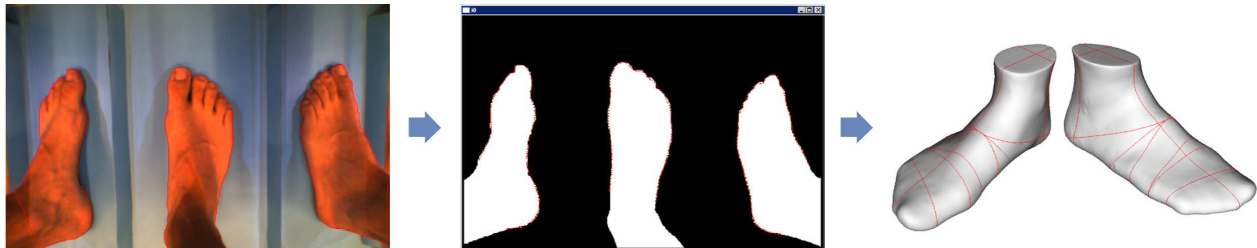
Figura 1. Metodología de reconstrucción 3D del pie con un dispositivo low-cost .
