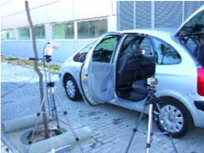
Fotogrametría aplicada al análisis de los movimientos de entrada y salida de un automóvil.
