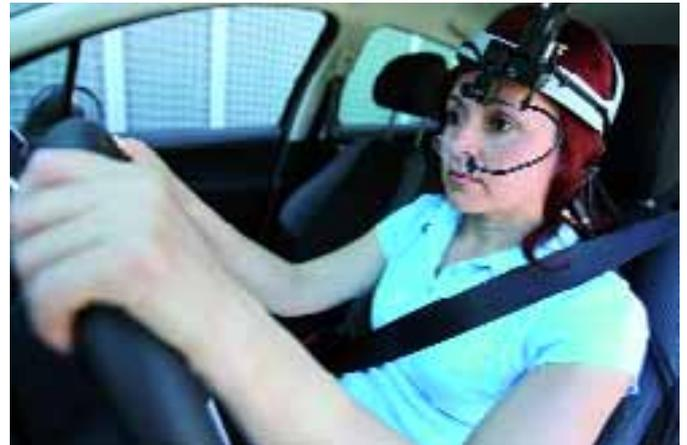
Sistema Eye-tracker empleado para determinar la orientación del punto de mirada mientras se utiliza un sistema HMI.
