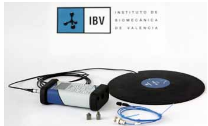
Figura 5. Equipo de adquisición de vibraciones para la medición de vibraciones en puestos de conducción.
