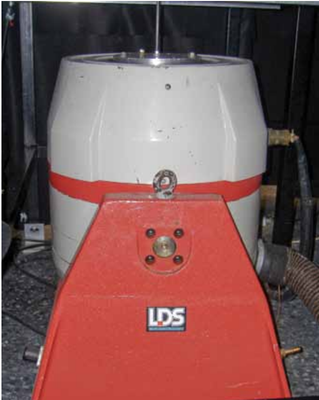
Figura 2. Excitador electrodinámico utilizado en la plataforma.
