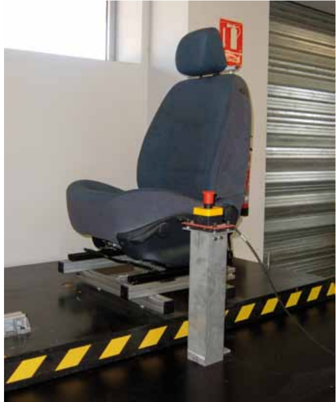
Figura 3. Botón de parada tipo seta situado en el área de alcance del sujeto de ensayo.
