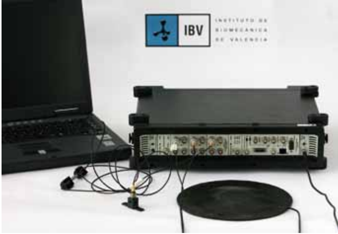
Figura 6. Equipo de adquisición de vibraciones para la medición de vibraciones en pasajeros.
