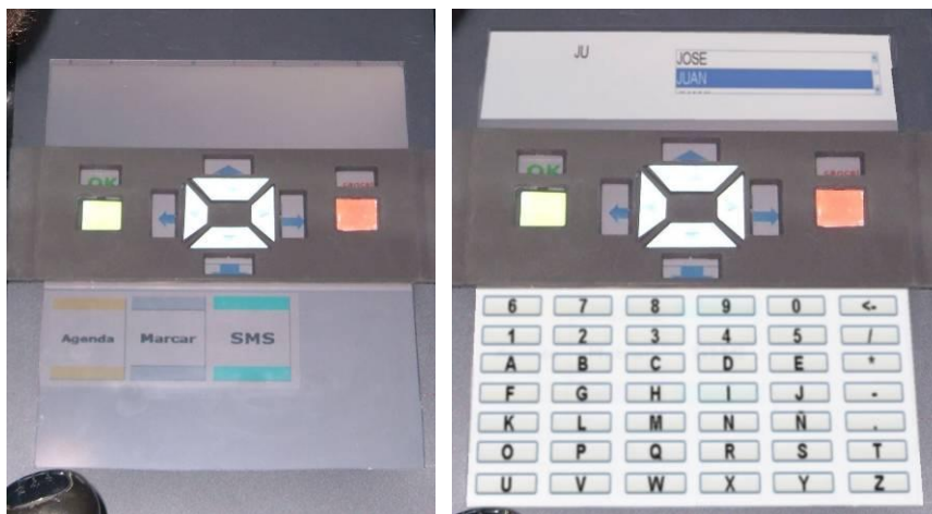
Figura 2. IVIS en la pantalla inicial (izquierda), y en la función de agenda (derecha)
