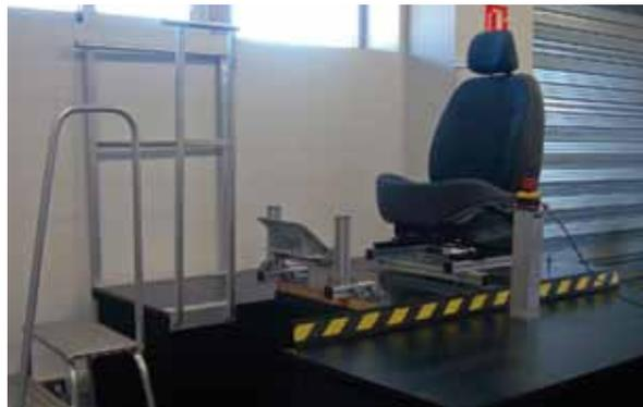
Figura 1. Laboratorio de ensayos dinámicos de asientos de vehículos.
